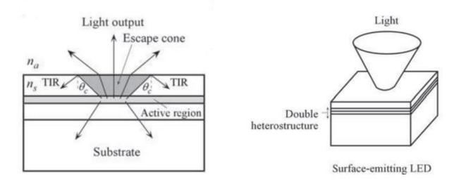
Figure 1 - Photon Escape Angle<sup>1</sup>
